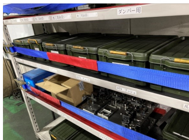
地震対策で張られたラッシングベルト
